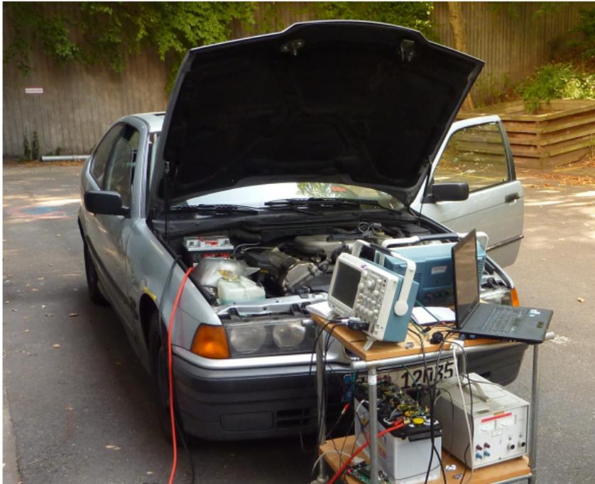
Kombinierter Test drahtloser Sensoren mit verdrahteter Messtechnik als Referenz
