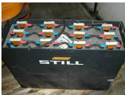
Gabelstaplerbatterie mit Versuchssensoren
