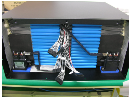
E-Autobatterie mit Anschlüssen für Batterieüberwachung
